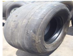
Trace d'une lampe de balisage du taxiway ainsi que déchirures au niveau du train principal
