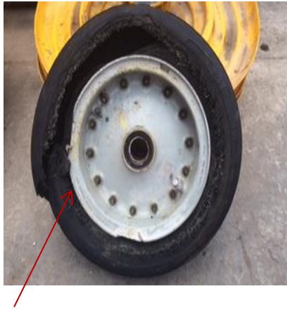
Dégâts enregistrés sur la jante gauche
