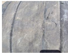
Trace d'une lampe de balisage du taxiway ainsi que déchirures au niveau du train principal
