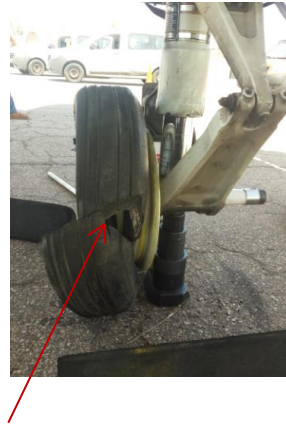
Dégâts enregistrés sur la roue gauche du train avant.
